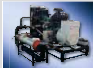
MAN Logistik-Zentrum Augsburg 150 kW elektr. Pflanzenöl-BHKW
